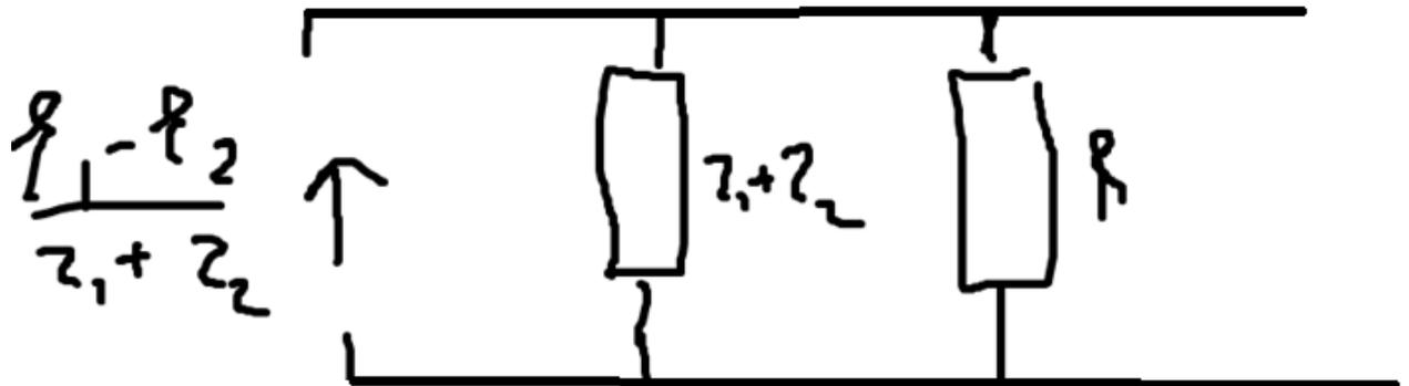
Два параллельно соединённых резистора можно объединить в один.
